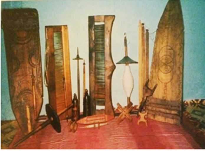
Fotoğraf 9. Ketan Kumaş Dokuma Tezgâhı Parçaları, Kaynak: Geçmişten Geleceğe Çaykara Dernekpazarı, s. 550
