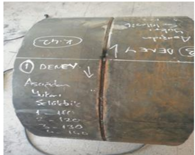
Şekil 3. Kaynak işlemi için hazırlanan borular (Pipes prepared for welding process)
