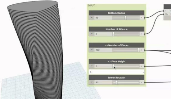
Şekil 2: Dynamo Parametrik Tasarım Modeli
