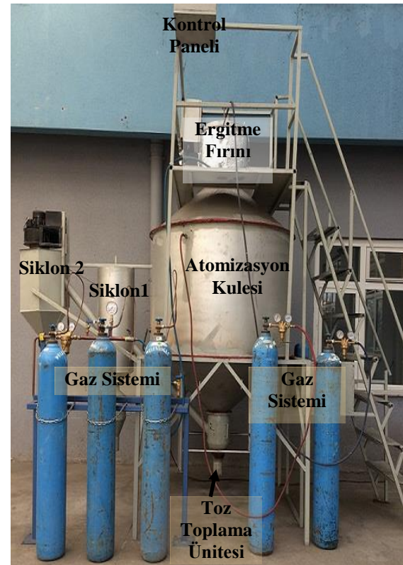
Şekil 1. Gaz Atomizasyon Ünitesi
