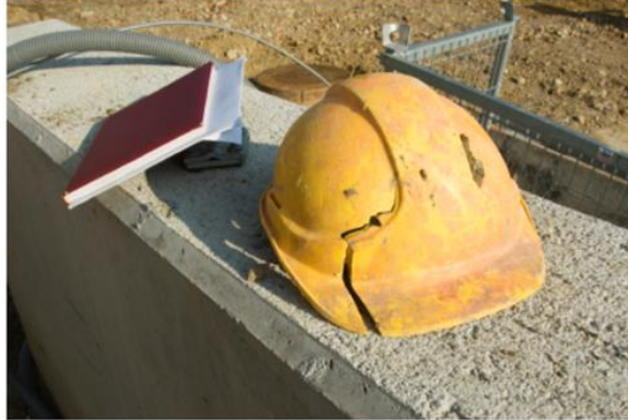
Şekil 4. Yüksekten cisim düşmesi sonucu zarar gören baret
