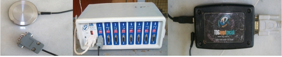
Şekil 3 - Deneylerde kullanılan basınç ölçer, veri toplama ünitesi ve aygıt geçidi
