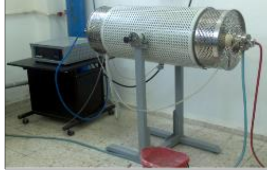
Şekil 2. Deneysel çalışmada kullanılan Atmosfer kontrollü fırının görüntüsü.
