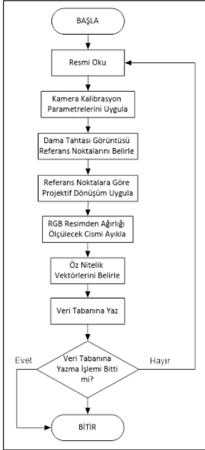
Şekil 7: Veri tabanına veri yazma süreci akış diyagramı
