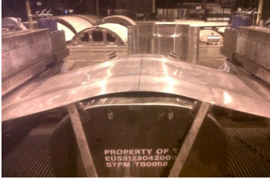
Şekil 19. Temel Eğitim ve Başlangıç Uçağı ön kokpit panelinin şekillendirilmesi (750 ton kapasiteli Cyril-Bath tezgahı)
