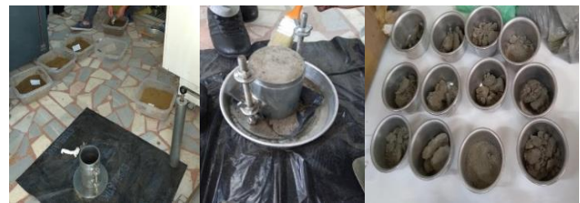
Şekil 6. Uçucu kül-kil karışımları üzerinde yapılan Standart Proktor deneyi (a-b)
