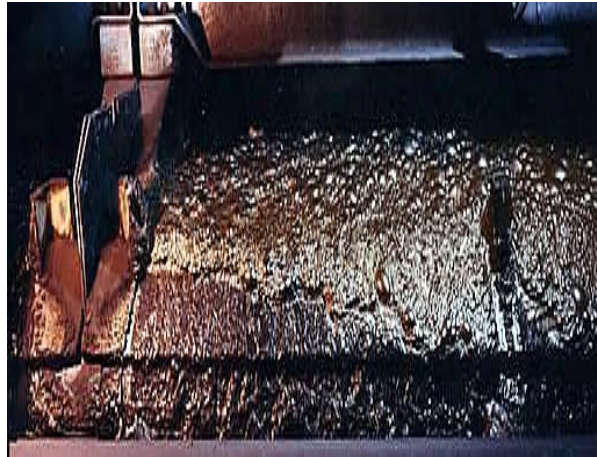
Şekil 29. Yakın çekim flotasyon hücresi
