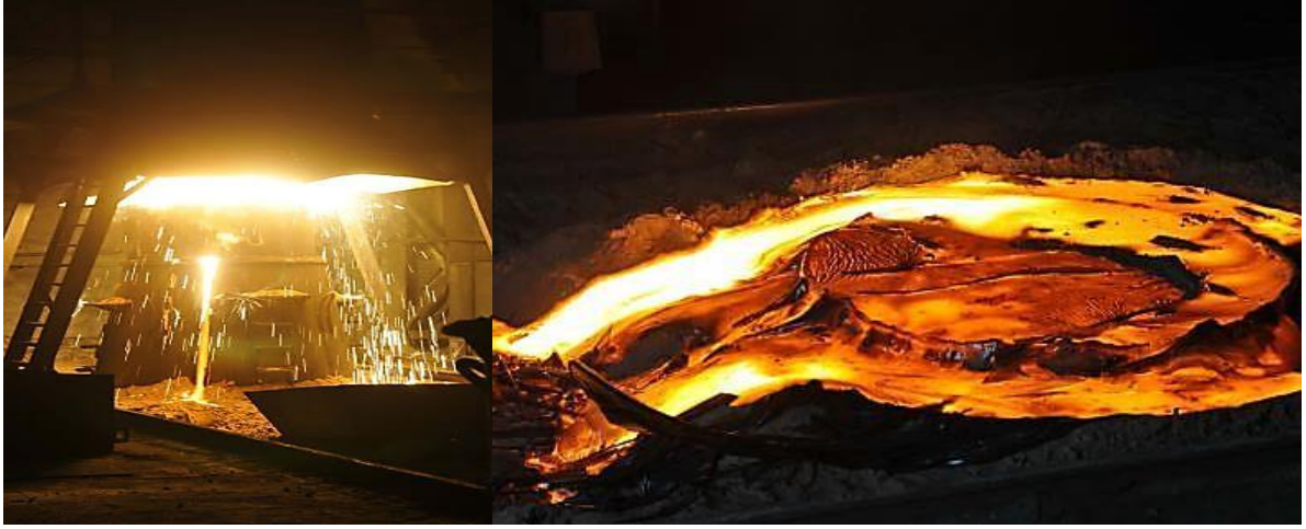
Şekil 15. Cüruf oluşması ve katılma işlemi
