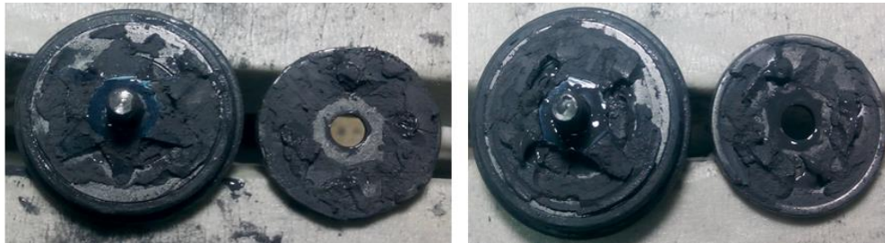
Şekil 21. Klasik taban valf sisteminde MR sıvının topaklanması
