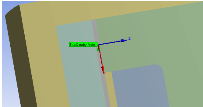
Şekil 5. Manyetik akı yoğunluğunun amortisör üzerinde okunduğu nokta
