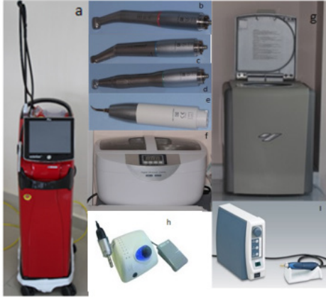
Şekil 3. Elektrik ve manyetik alan ölçümü gerçekleştirilen cihazlar (a: Sert-yumuşak doku lazeri, b: Kırmızı kuşaklı anguldruva, c: Mavi kuşaklı anguldruva, d: Endodontik anguldruva, e: Kavitron, f: Ultrasonik temizleyici, g: Aljinat karıştırma cihazı, h: Masa tipi mikromotor, ı: Dizden basmalı mikromotor)
