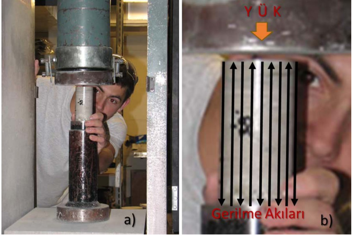
Şekil 12. Kayadan hazırlanmış karot örnekte (taş, monolit) tek eksenli basınç deneyi. Figure 12. Uniaxial pressure test on rock sample prepared from rock (stone, monolith).
