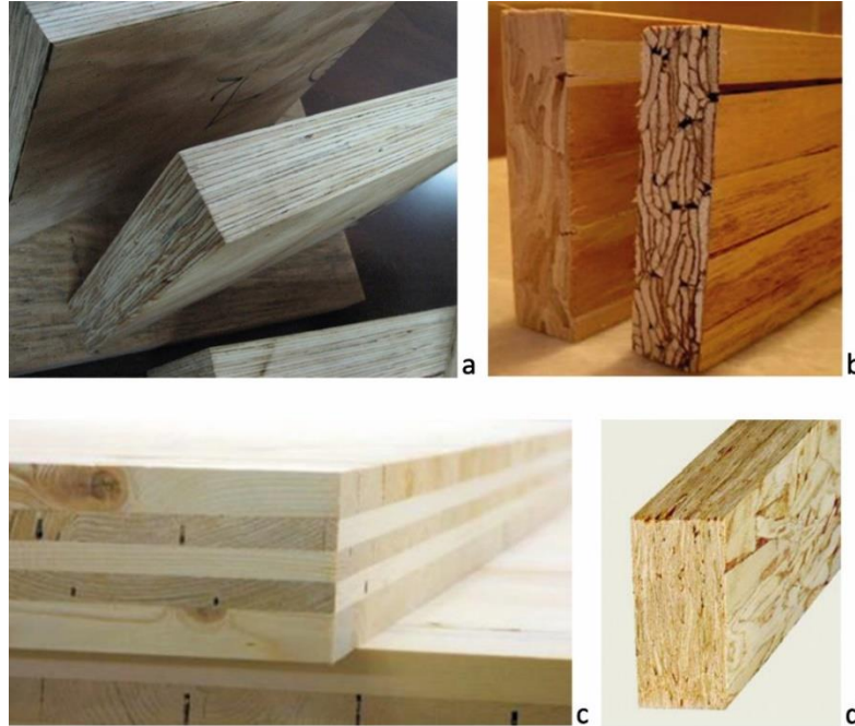
Şekil 2. Tutkallı tabakalı ahşap yapı elemanlarındaki son gelişmeler: (a) LVL- Lamine Kaplama Kereste (Laminated Veneer Lumber) (URL- 1), (b) PSL- Paralel Şerit Kereste (Parallel Strand Lumber) (Çavuş, 2008), (c) CLT- Çapraz Lamine Ahşap (Cross Laminated Timber) (URL -2) ve (d) LSL – Tabakalı Şerit Kereste(Laminated Strand Lumber) (URL-3).
