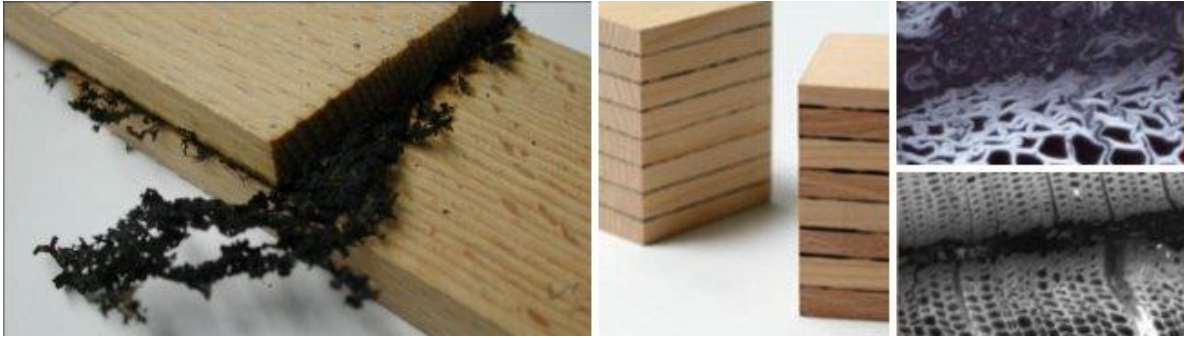
Şekil 3. Sürtünme kaynaklı ahşap birleştirme (URL-3).
