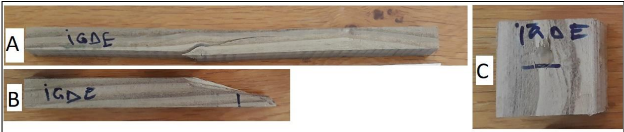
Şekil 1. Eğilme direnci (A), şok direnci (B) ve statik sertlik (C) test örnekleri test sonrası görüntüsü.
