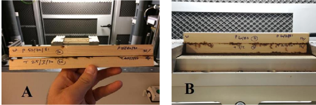
Şekil 9. %13-14 rutubetteki çam odunun kaynaklama sonrası kötü bir birleşme görüntüsü (A), %10-11 rutubetteki çam odunun kaynaklama sonrası iyi bir birleşme görüntüsü (B) (Zor vd., 2019).
