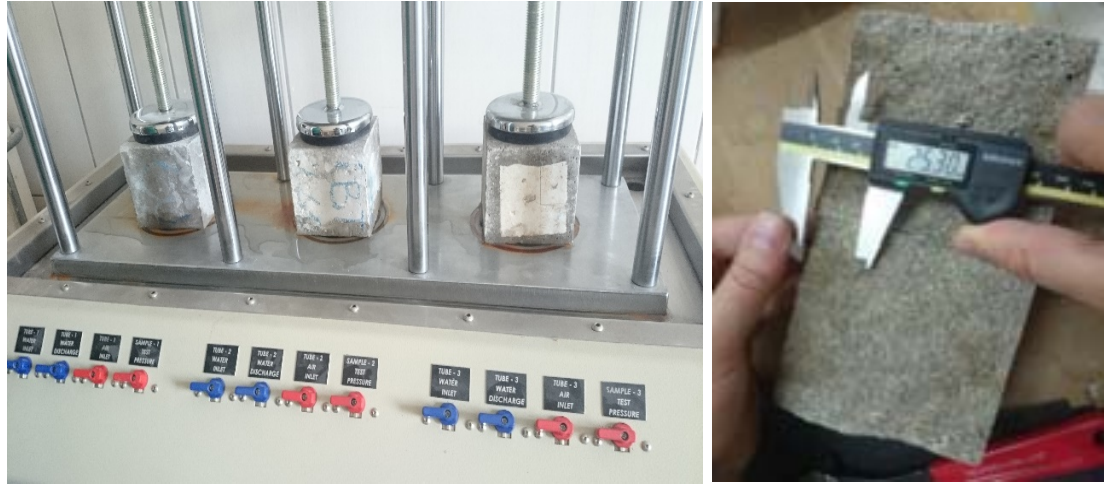
Şekil 1. Basınç altında su işleme derinliğinin tayini.
