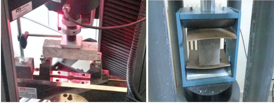
Şekil 2. Harç numunelerinde eğilme ve yarmada çekme deneyi.
