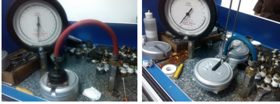
Şekil 6. Yay karakteristiği çıkarma düzeneği.
