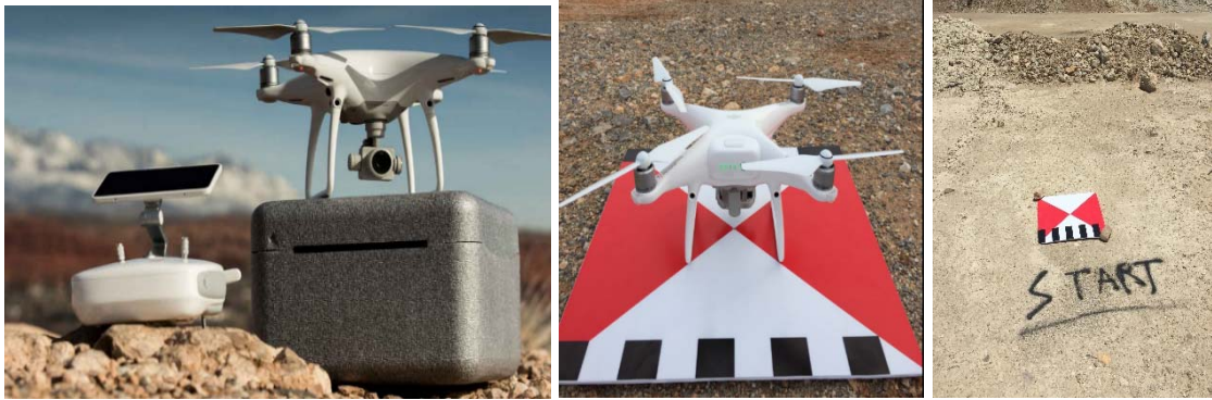
Şekil 1. Saha çalışmalarında kullanılan İHA ve alan kontrol noktası örneği.
