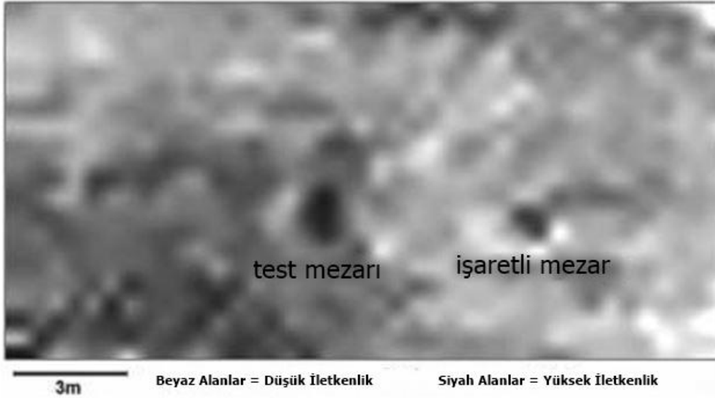
Resim 3. Mezar Yeri Tespitinde Elektromanyetik Görüntüleme Örneği (Cheetham, 2005)
