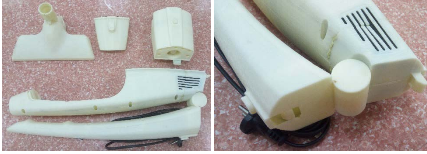
Şekil 6. Bütün parçaların prototipleri ve kol kitleme kısmı
