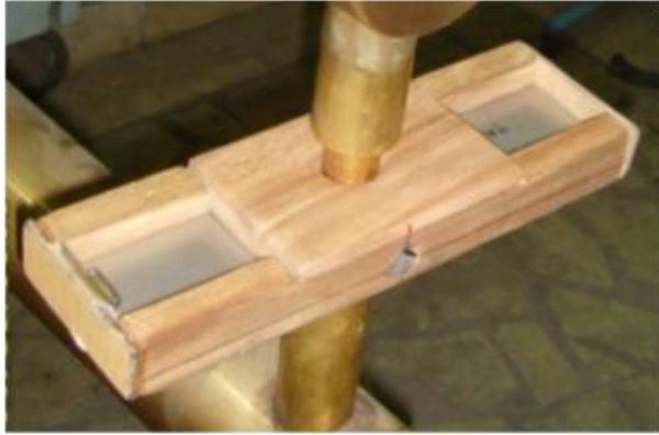
Şekil 2. Kaynak esnasında kullanılan kalıp görüntüsü (The image of the mould used during welding)
