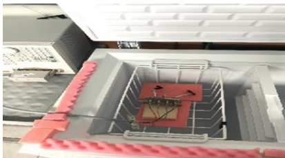
Şekil 2. Piezoelektrik sensöre probaların bağlanış şekli (Connection of the probes to the piezoelectric sensor)
