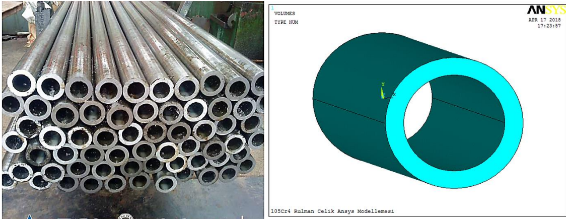
Şekil 2. Çelik rulman tüplerin uygulama sanayisindeki ham hali ve ANSYS yazılımındaki modellemesi
