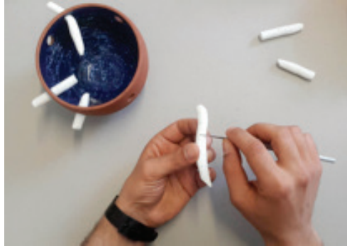
Görsel 20. Keskin Uçlu Aletler Yardımıyla Lületaşının Şekillendirilmesi.
