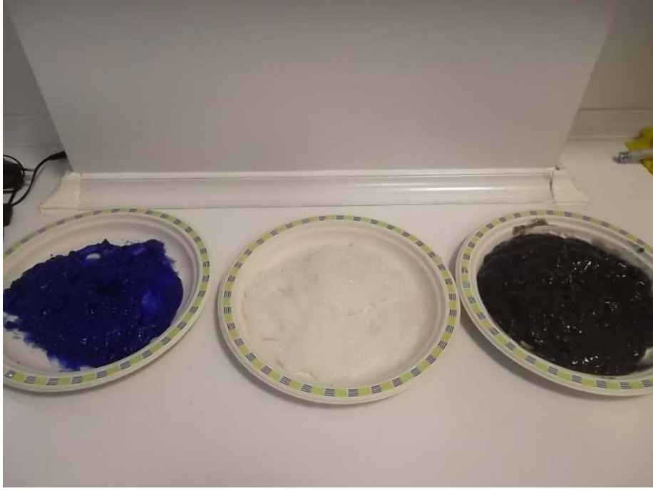
Fig. 8 Çividli, katkısız ve kalaylı nişasta aharları.
