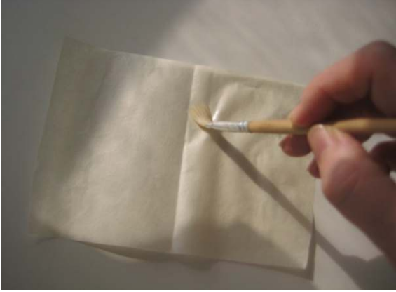
Fig.8. Yırtılma direncinin hesaplanması için örneklerin hazırlanması.
