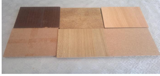
Şekil 1. Isı iletim katsayısı için hazırlanmış lif levha ve kaplanmış lif levhalar
