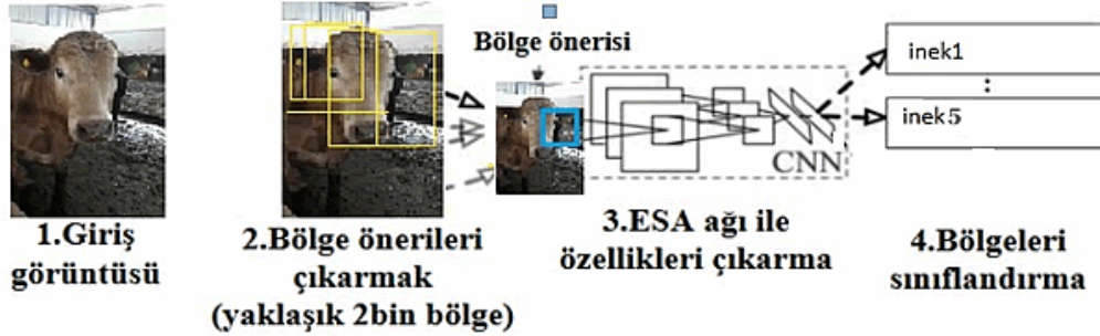
Şekil 5. DHB-ESA modelinin genel mimari yapısı
