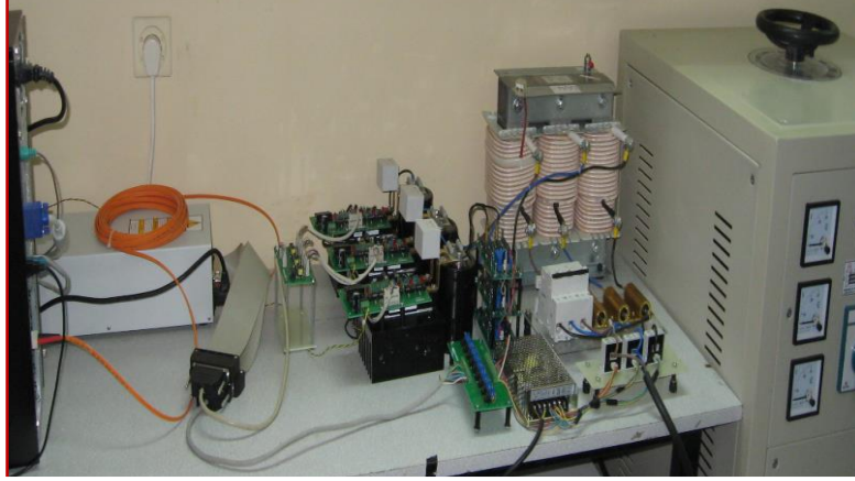
Şekil 7. D-STATKOM'un deneysel kurulumu
