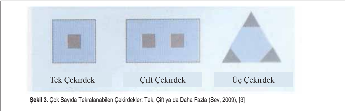
Şekil 2. Yüksek Yapılarda Çekirdek Düzenlemesine İlişkin Seçenekler (Sev, 2009), [3]
