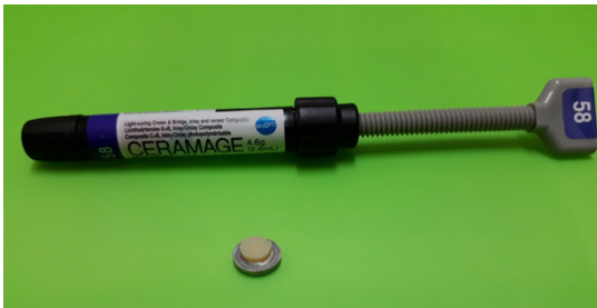
Şekil 4. Co-Cr alt yapı üzerine uygulanarak polimerize edilmiş Ceramage kompozit
