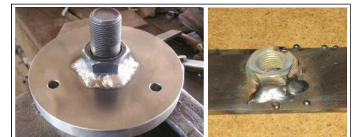
Şekil 1. Normal Bir Somunun Parçaya Kaynağı [9-11]
