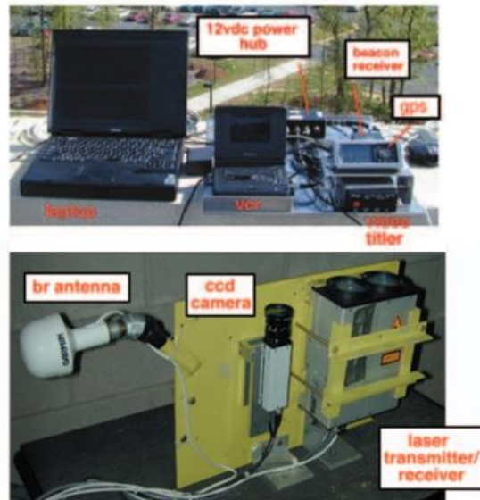
Şekil 1. PALS sisteminin bileşenleri (Nelson vd., 2003).
