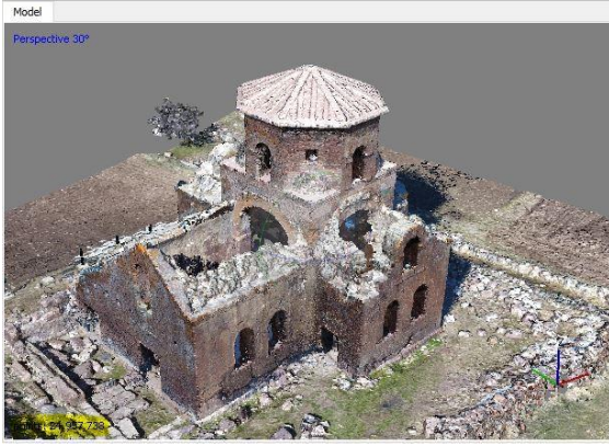
Şekil 10. Yoğun Nokta Bulutu (24,957,738 Point)
