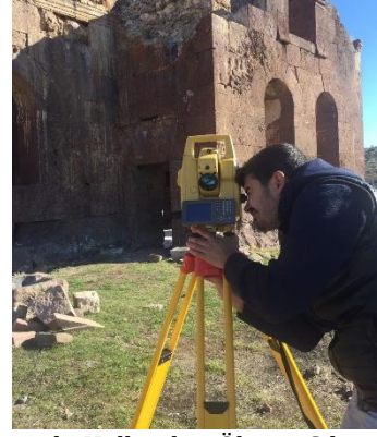
Şekil 4. Arazide Kullanılan Ölçüm Cihazı (Prizmasız : \pm (5\text{mm}) mse Prizmalı : \pm (3\text{mm} + 2\text{ppm} \cdot D^*) mse (MSE: Mean Square Error: Karesel Ortalama Hata)
