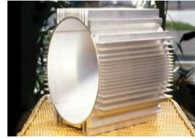
Şekil 13. Sürtünme Karıştırma Kaynağı Yöntemi ile Alüminyum Alaşımından İmal Edilmiş Motor Gövdesi ile Olimpiyat Stadında Kullanılan Alüminyum Birleştirme Elemanları [25-26]
