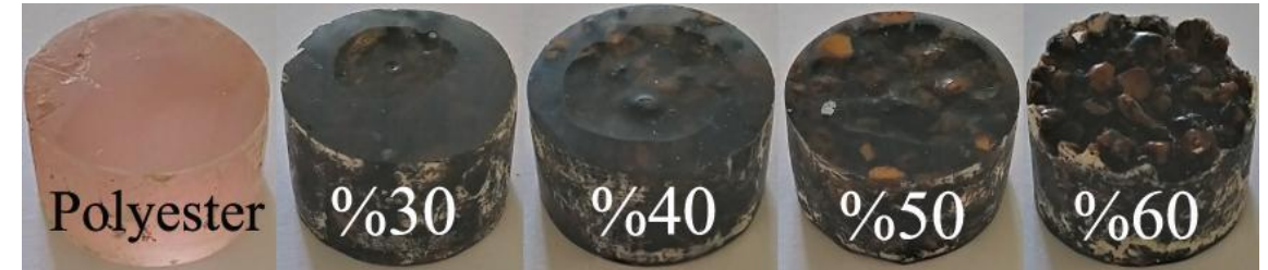
Şekil 3. Saf polyester ve %30, %40, %50, %60 Zeytin Çekirdeği Oranlarına Sahip Kompozit Malzemeler
