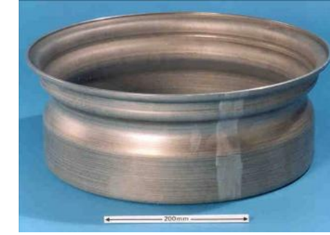
Şekil 12. Jantların ve Vites Kutusu Dişlilerinin Sürtünme Karıştırma Kaynağı ile Birleştirilmesi [24]
