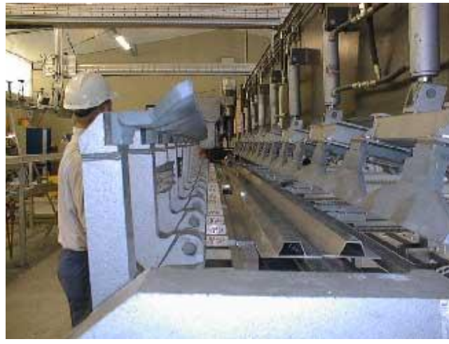
Şekil 10. Sürtünme Karıştırma Kaynağının Gemilerde Uygulanması ve Alüminyum Gemi Panellerini Kaynak İçin Kullanılan Sürtünme Karıştırma Kaynak Makinesi [27]
