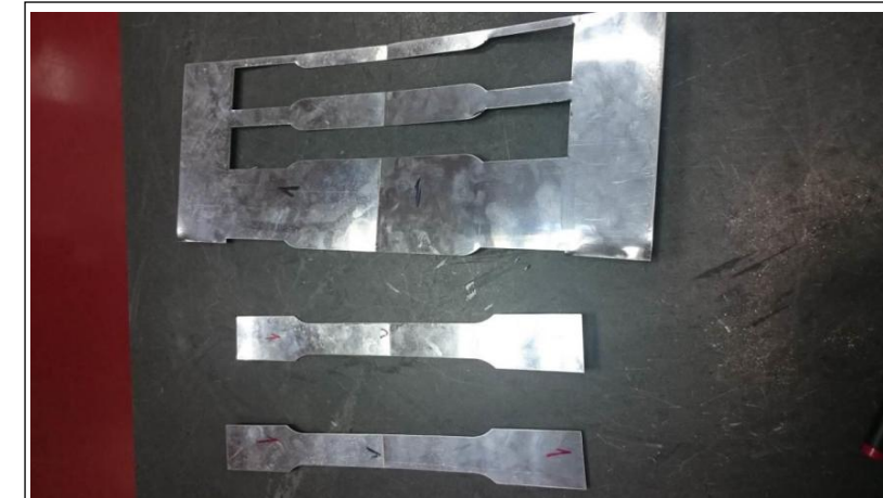
Şekil 1. Kaynaklı Parçaların Giyotinle Kesilmiş Görüntüleri
