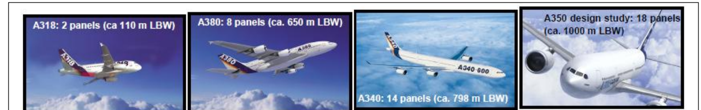
Şekil 8. Uçaklarda Kullanılan Laser Kaynak Bağlantılı Panel Sayısı ve Kaynak Dikişlerinin Uzunluğu [1]
