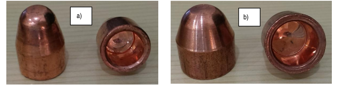
Şekil 3. Elektrot Tipleri: a) Z-Trode (Φ6 mm), b) N-Trode (Φ8 mm)
