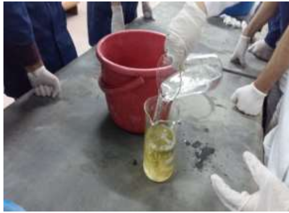
Şekil 6. Su azaltıcı katkı maddesi olarak kullanılan hiper akışkanlaştırıcı.
