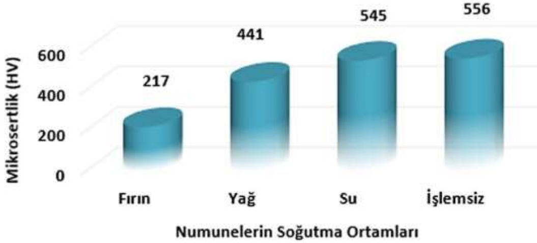
Şekil 4. Isıtma işlemi uygulanmış numunelerin mikro sertlik işlemleri
