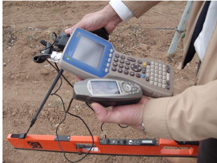
Şekil 3. EM38 sensörü, el bilgisayarı ve GPS
