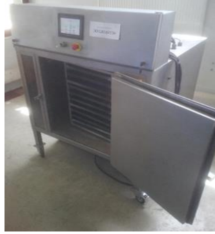
Şekil 1. Döner tepsili kabin tipi kurutucu.
