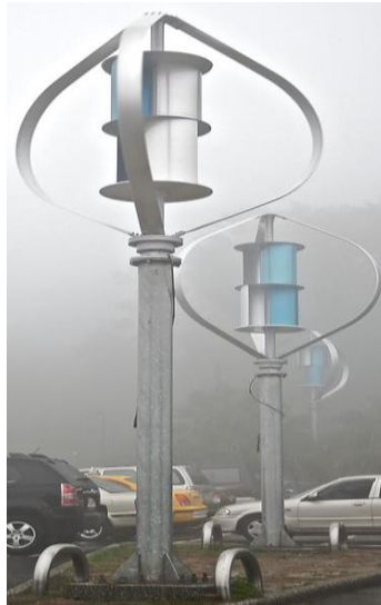
Şekil 8. Savonius ve Darrieus bütünleşik tasarımı [31]
