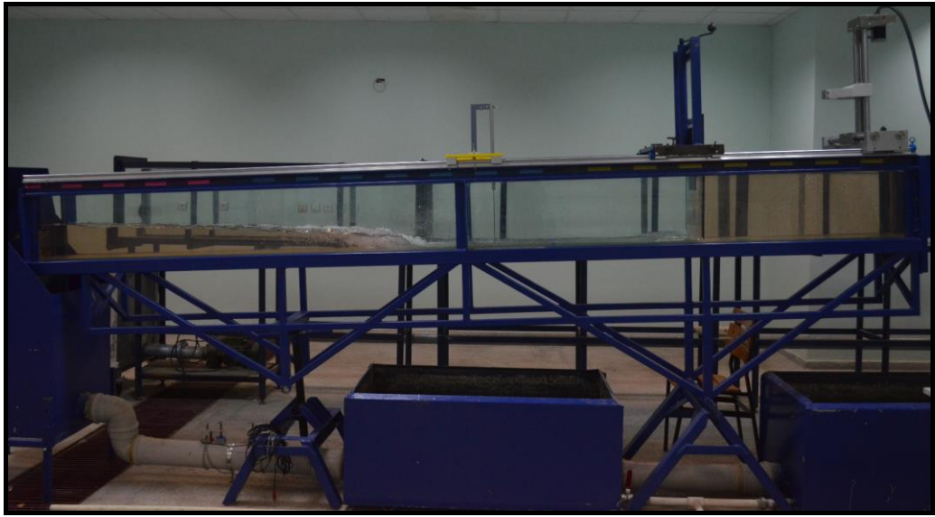
Şekil 2. Deneyde kullanılan açık kanal modeli
