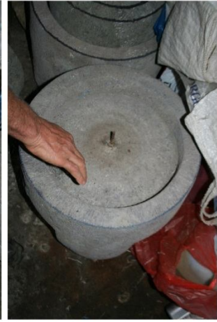
El değirmeni - ayaklı alt bölüm üst iç kısmı, iç yüzey merkeze doğru, üst taş tabanının yersine yukarı yönde meyilli, öğütülmüş parçalar yana, deliğe doğru ynlendiriliyor.
