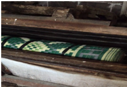
Fotoğraf 17. Keçe Tepme makinesi (Kılıç Karatay 2018).
