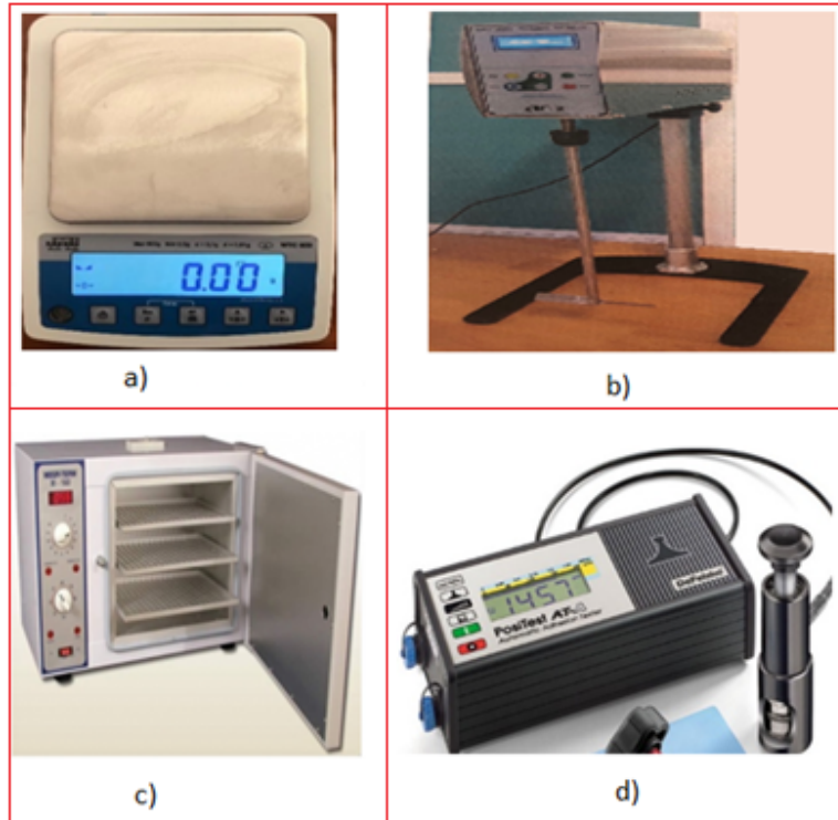
Şekil 3. Deney cihazları a) Hassas terazi b) Mekanik karıştırıcı c) Etüv d) Pull-off test cihazı
