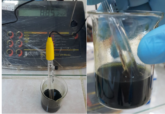
Şekil 4. Trietanol amin eklenmeden hazırlanan demir sitrat çözeltisinin pH dayanımının incelenmesi
