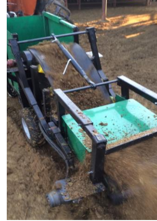
Şekil 22. Aracın ağır atıkla test edilmesi
