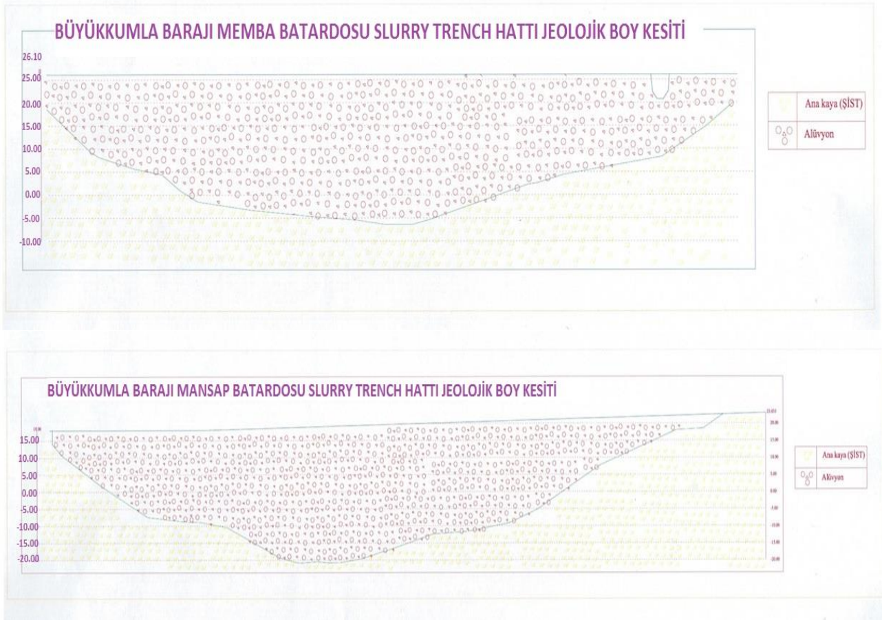
Şekil 3. Memba ve mansap batardosuna ait jeolojik kesit
