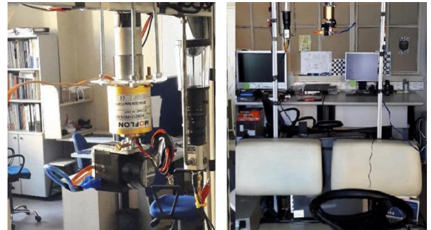
Şekil 14. Otonom golf aracı üzerine kurulan sistem
