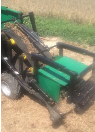
Şekil 21. Aracın hafif atıkla test edilmesi
