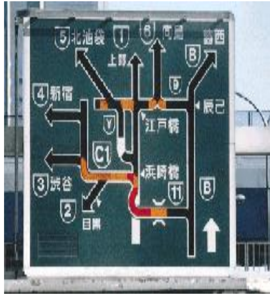
Şekil 3. Grafik rota bilgi panellerinin Japonya'da kullanımı (Using graphical route information panels in Japan) [2]
