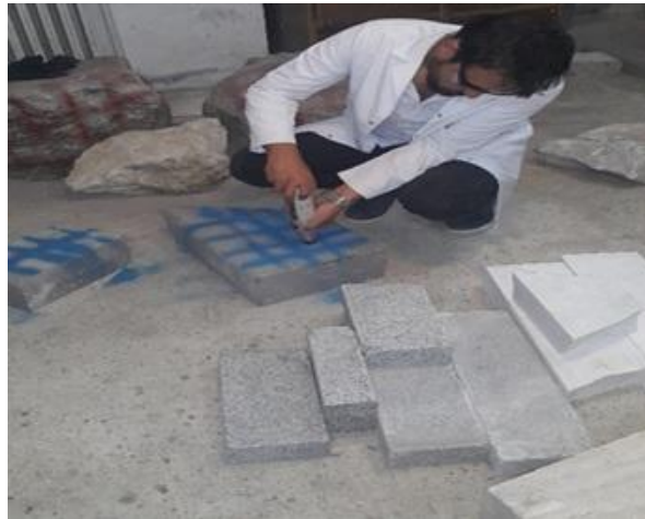
Şekil 3. Kayaçların Schmidt sertliği değerlerinin belirlenmesi
