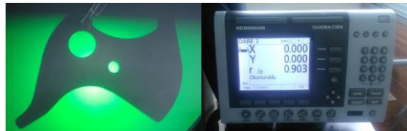
Şekil 7. Projeksiyon cihazında radius ölçümü (PR9 Numune ölçümü)
