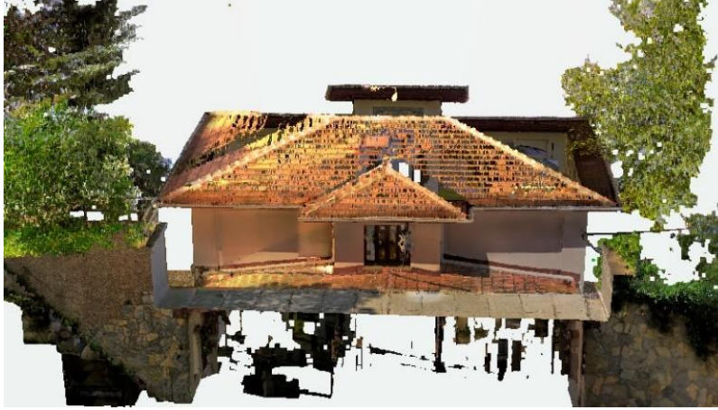
Şekil 6. Nokta bulutlarından üretilmiş binanın kısıtlayıcı arka cephesi
