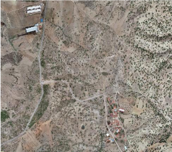
Şekil 6. Pix4D yazılımında üretilen ortofoto görüntüsü
