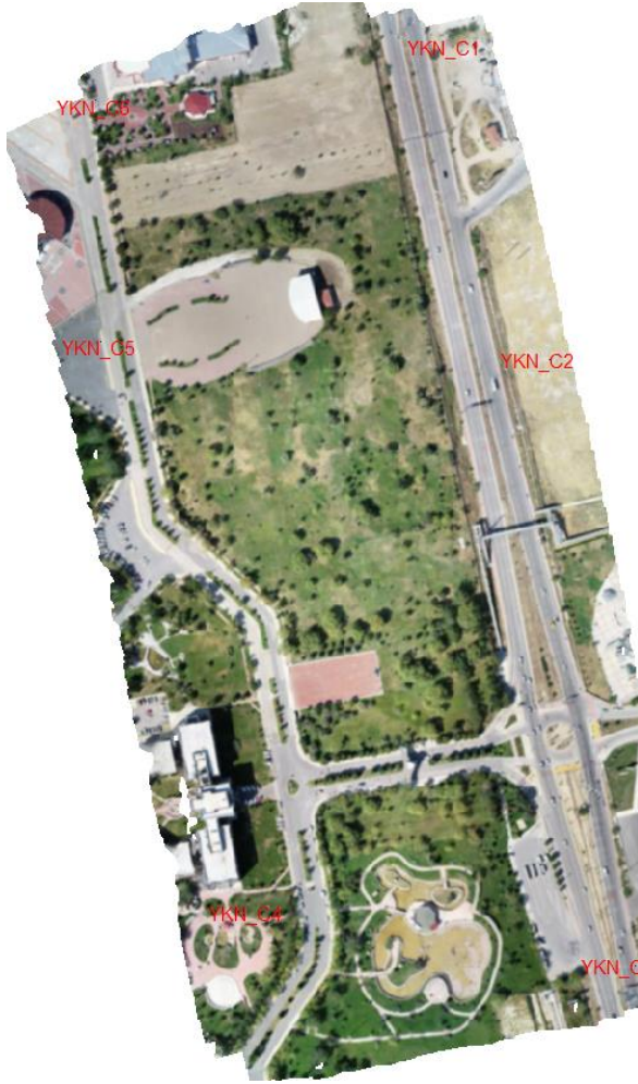
Şekil 4. Çalışma Alanında İşaretlenmiş YKN'ler
