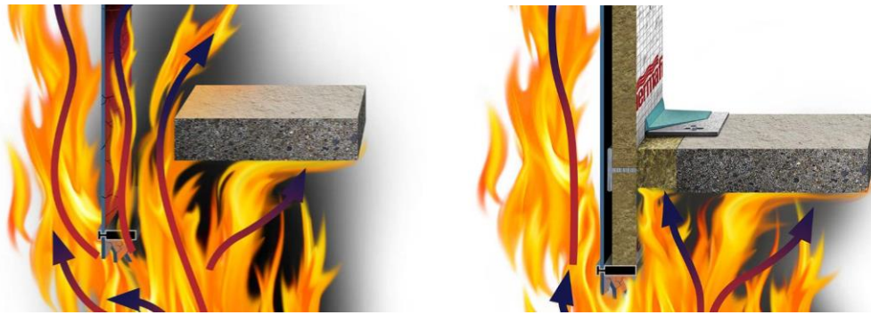
Şekil 6. Cephe ve döşeme birleşimlerinde sızdırmazlığın sağlanması (Ogino, 2019)
