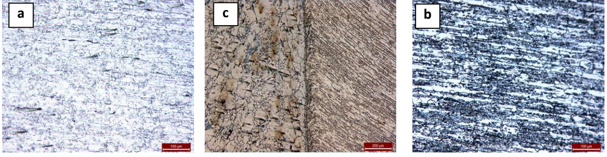
Şekil 7. AISI 430 - AISI 304 numunesine ait mikroyapı resimleri (a) AISI 430 ana malzemesi, (b) kaynak ara yüzeyi ve ITAB (c) AISI 304 ana malzemesi.
