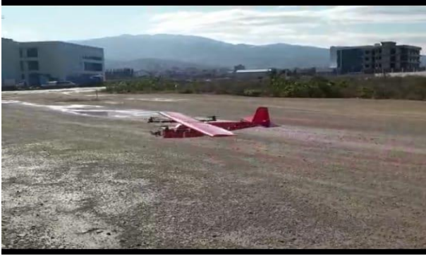
Şekil 11. VTOL İHA'nın test uçuşu
