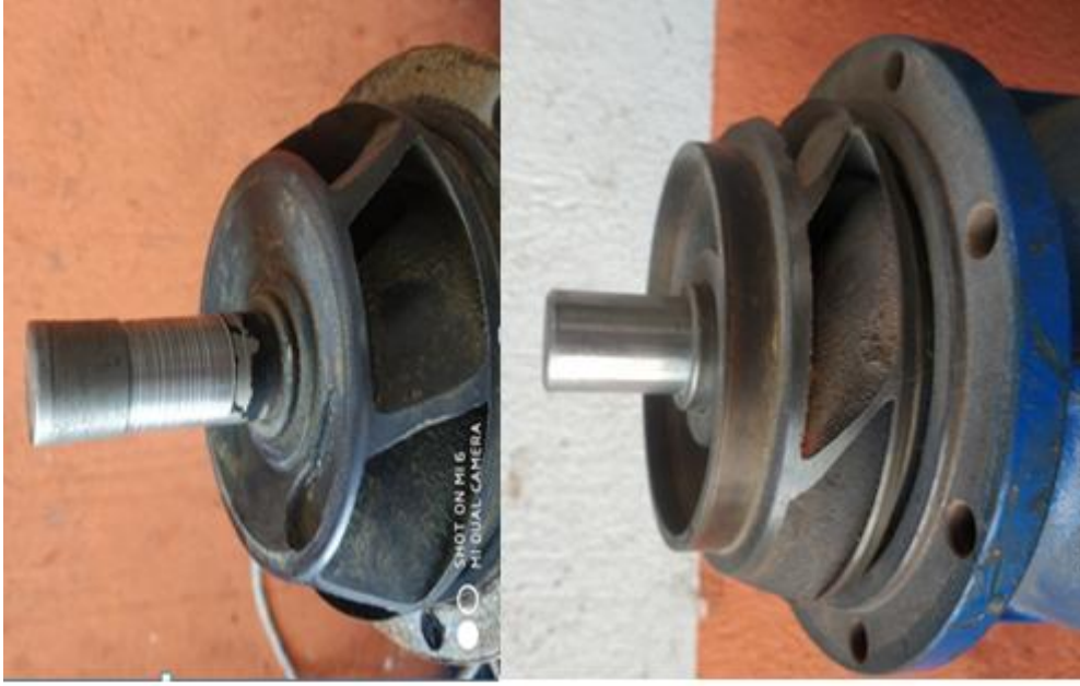
Şekil 8. Mil aşınması Figure 8. Shaft amortization
